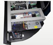
旋转设计将伺服驱动和电控箱分开安装,避免强弱电干扰,方便检修。
