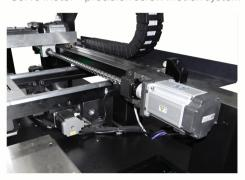
X.Y轴由伺服电机控制丝杆运动、精度高、速度快,效率得到保障。
