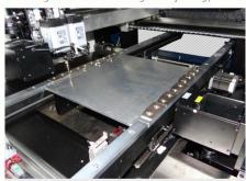
轨道宽度通过软件标定,输入宽度后自动调整 小平台支持顶针。
