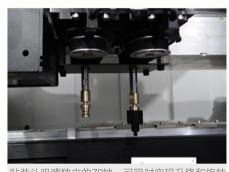
贴装头吸嘴独立的ZR轴,可同时实现升降和旋转 保证贴装精度和效率。
